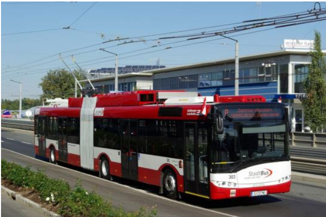
Abbildung 3-6: Aufladung über Oberleitungen (Greencarcongress, 2016)
