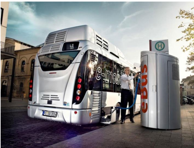
Abbildung 3-5: Aufladung über eine Ladestation (Stadt Hamburg, 2017)
