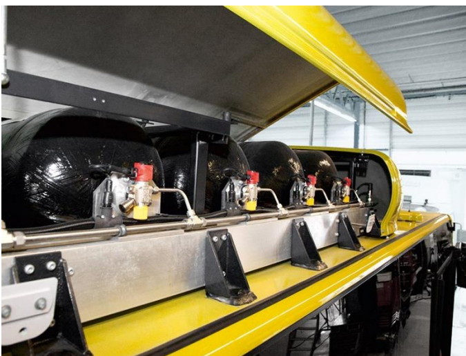
Abbildung 3-13: Gasdruckbehälter auf Busdach (MAN, 2017)
