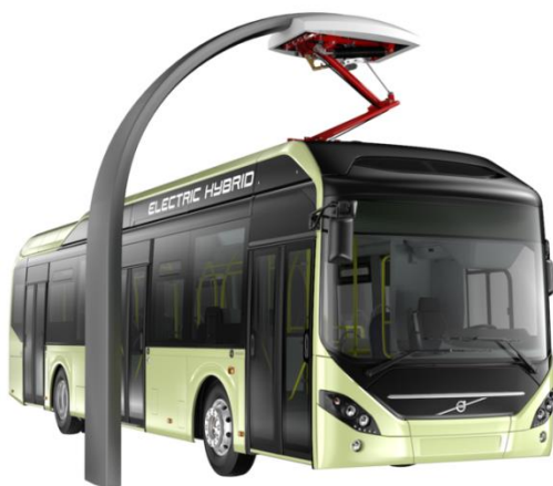
Abbildung 3-7: Aufladung über Onboard-Pantografen (gas2, 2014)
