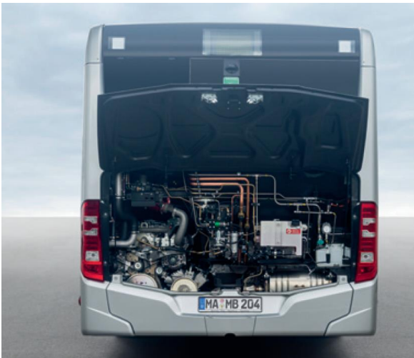
Abbildung 3-12: Erdgasmotor, Abgasanlage und Tankinstrumentarium (Blickpunkt, 2016)
