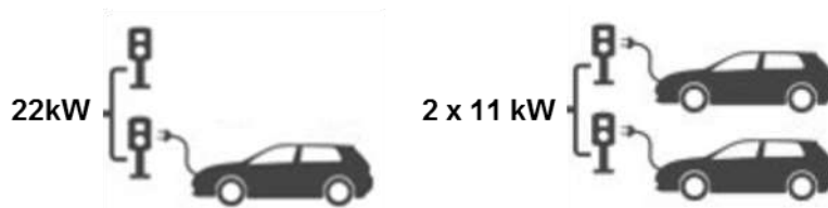
Abbildung 7-4: Schema integriertes Lastmanagement
