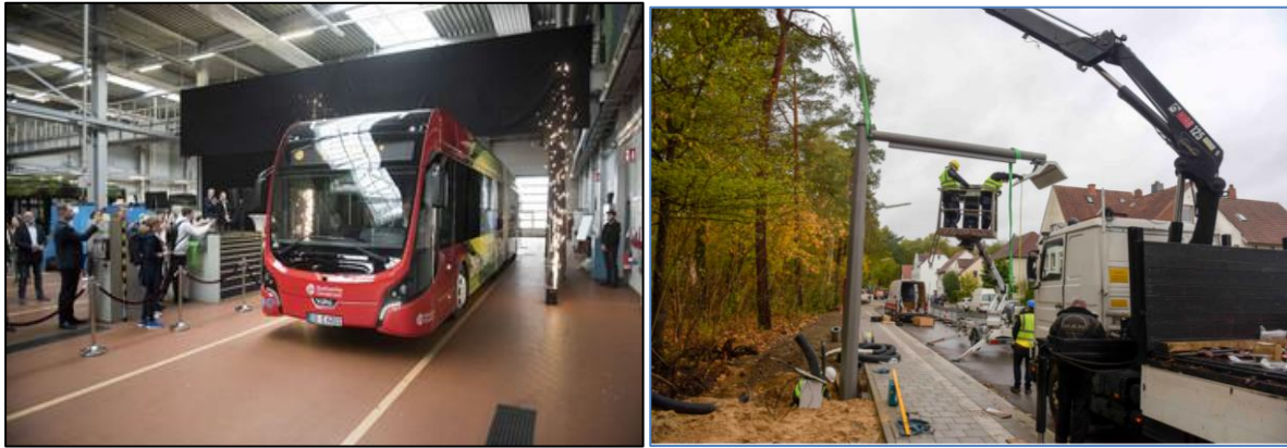
Abbildung 2: (links) Neuer Elektrobus der Stadtwerke Osnabrück vom Typ VDL Citea SLFA-181 (rechts) Bauarbeiten für das "Stromtanken" durch Schnelllademaster der E-Busse in Düstrup (Quelle: Stadtwerke Osnabrück 2018)
