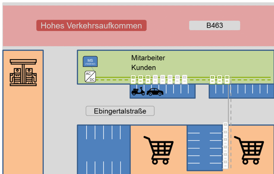
Abbildung 33: Schematische Darstellung von Mobilitätsformen, der Ladeinfrastruktur und deren Versorgung sowie mögliche Erweiterung
