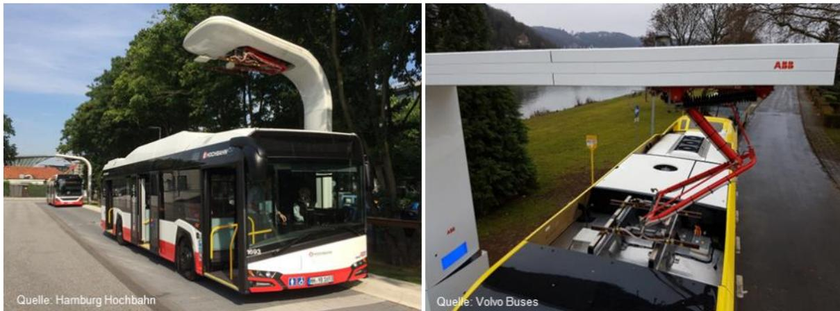
Abbildung 9: Konduktives Laden via Pantographen
