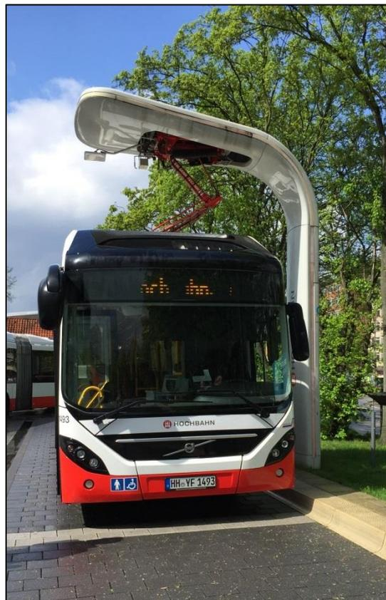
**Abbildung 33: Pantograph bei der Hamburger Hochbahn AG**
