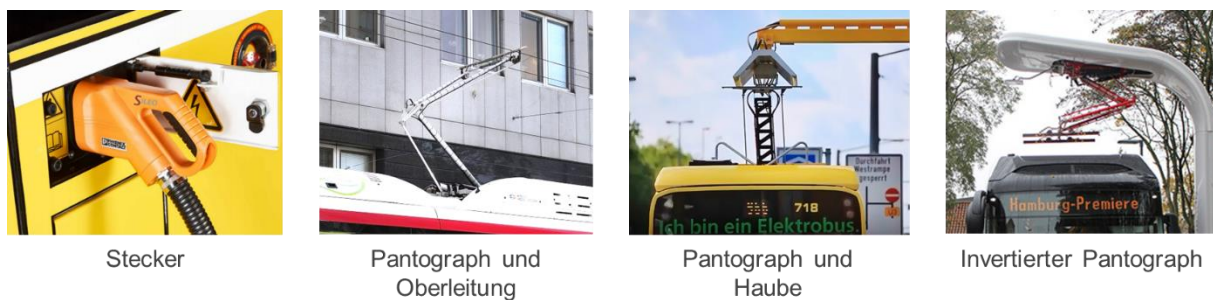
Abbildung 9: Varianten der konduktiven Kopplungstechnik
