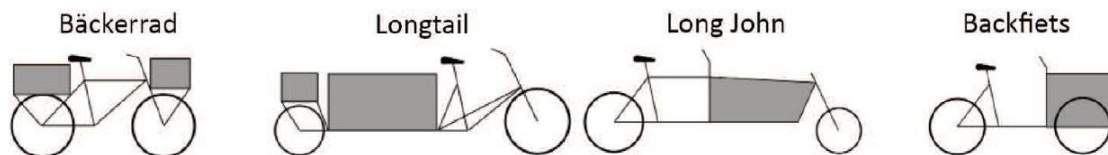
Abbildung 40 Bauweisen von Lastenrädern 75
