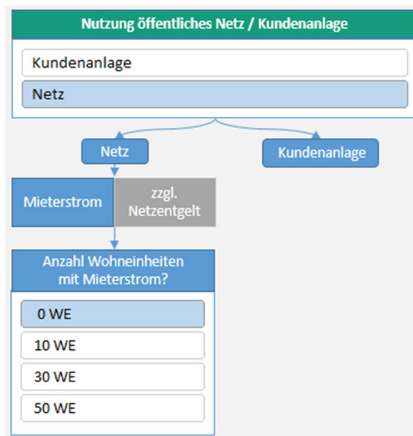
Abbildung 17: Ausschnitt aus der Mikrosimulation: Integration der Photovoltaik-Anlage an demselben Netzverknüpfungspunkt wie die Ladeinfrastruktur (Kundenanlage) oder Zuführung über das öffentliche Verteilnetz (Netz).
