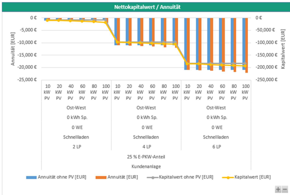
Abbildung 30: Vergleich der Wirtschaftlichkeit gemeinsam genutzter Ladepunkte für die WIRO-Bewohner mit hoher Ladegeschwindigkeit mit und ohne Photovoltaik-Anlage bei Investitionskosten von 1.400 €/kW und einem Netzstrompreis von 20 ct/kWh.
